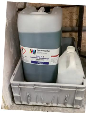
Solution de mouillage sans alcool sur bac de rétention
